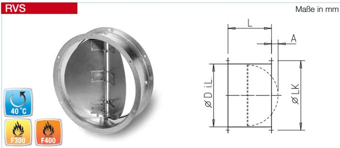
**Selbsttätige Rohrverschlussklappe mit Federrückstellung<sup>1)</sup>** Horizontal in jede Richtung, vertikal mit Durchströmung von unten nach oben einbaubar. Klappenöffnung in Strömungsrichtung; automatische Funktion durch Ventilatorbetrieb.
