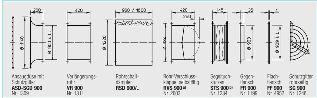
a) Verschlussklappe, motorbetätigt siehe Helios Hauptkatalog      b) Typen für ex-geschützte Ventilatoren siehe unten
