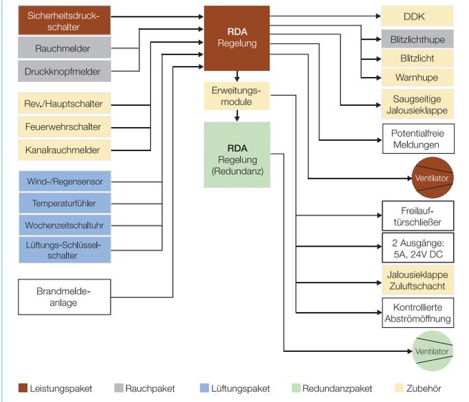
Rauchschutz-Druckanlagen sorgen im Brandfall durch den Aufbau eines Differenzdrucks für die Rauchfreiheit von Treppenträumen, Schleusen, Feuerwehraufzügen und deren Vorräumen.
