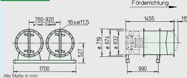
**Montagepaket MP-Z für zweistufige Z-Einheit**
