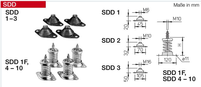
**Schwingungsdämpfer für Druckbelastung** zur schwingungs- und geräuschisolierenden Aufstellung von Ventilatoren. Liefereinheit 1 Satz = 4 Stück.
