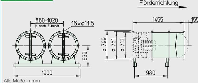
**Montagepaket MP-Z für zweistufige Z-Einheit**
