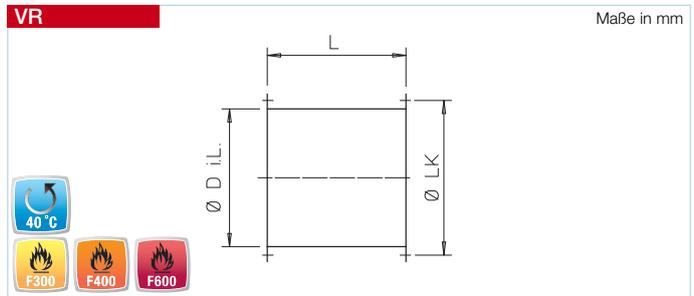
**Verlängerungsrohr VR** Rohrstück mit beidseitigen Flanschen und Bohrungen nach DIN 24155, Bl. 2. Aus feuerverzinktem Stahlblech, zur Verlängerung des Ventilatorschachtes.
