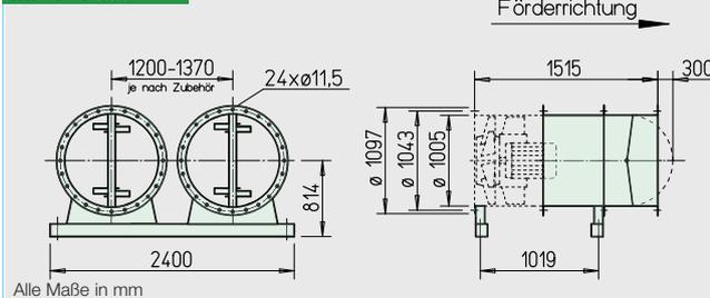
**Montagepaket MP-Z für zweistufige Z-Einheit**
