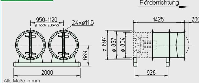
**Montagepaket MP-Z für zweistufige Z-Einheit**
