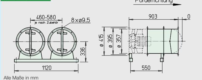
**Montagepaket MP-Z für zweistufige Z-Einheit**
