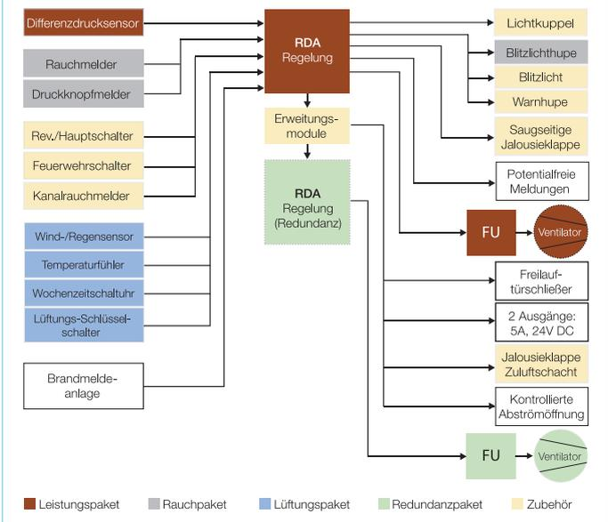
Rauchschutz-Druckanlagen sorgen im Brandfall durch den Aufbau eines Differenzdrucks für die Rauchfreihaltung von Treppenträumen, Schleusen, Feuerwehraufzügen und deren Vorräumen.
