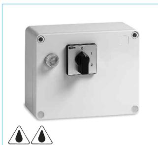
**Für polumschaltbare Drehstrom-Ventilatoren mit Dahlander-Wicklung und Thermokontakten**
