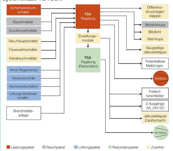
Treppenhaus-Spüllüftungsanlagen mit geregelter Druckhaltung realisieren im Brandfall eine Verdünnung und Ausspülung der in den Rettungsweg eingedringene Brandgase. Zusätzlich wird durch den Aufbau eines geregelten Differenzdrucks ein weiterer Raucheintrag in den Rettungsweg verhindert.
