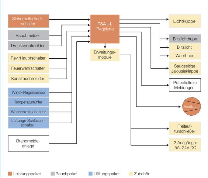
Helios Treppenhaus-Spüllüftungsanlagen sorgen im Brandfall durch Ausspülung für eine deutliche Verdünnung der Rauchgaskonzentration in Treppenträumen und erhöhen dadurch die Chancen für eine schnelle und erfolgreiche Eigenrettung.
