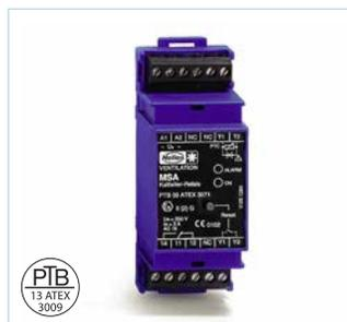
Bei Erreichen der Nenn-Ansprechtemperatur eines Kaltleiters fällt das eingebaute Relais ab. Störung wird durch eingebaute Leuchtdiode angezeigt. Wiedereinbetriebnahme durch Drücken der Taste „Reset“ oder über extern anschließbaren Schalter. Kunststoffgehäuse für Schaltschrankinstallation auf Tragschiene nach DIN EN 60715.
