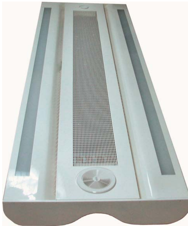
Koelbalk VFK 600-MS met lineaire armatuur, luidspreker en sprinkler.
