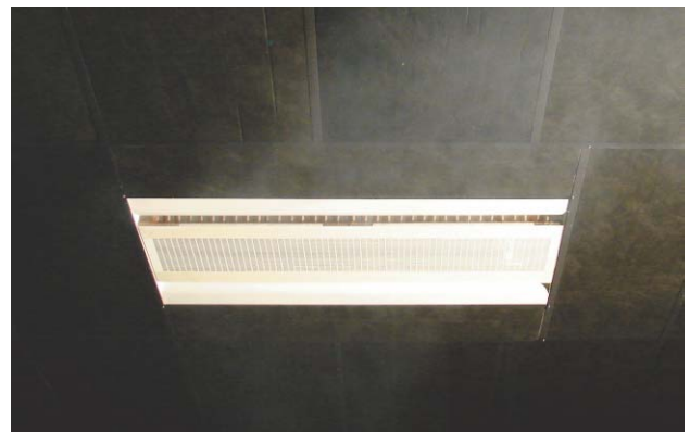
Test in Koolair-laboratorium. Afbuiging van de luchtstraal 45°
