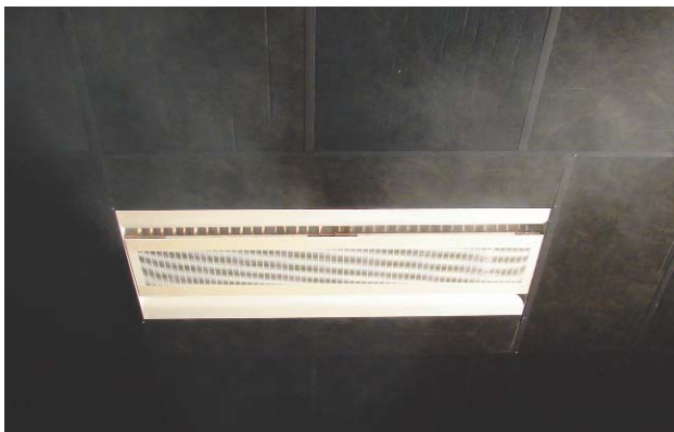
Test in Koolair-laboratorium. Richting van de luchtstraal in V
