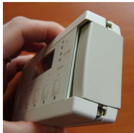
Er zijn 2 openingen voor de bevestiging
