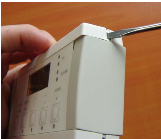
Gebruik een smalle schroevendraaier
